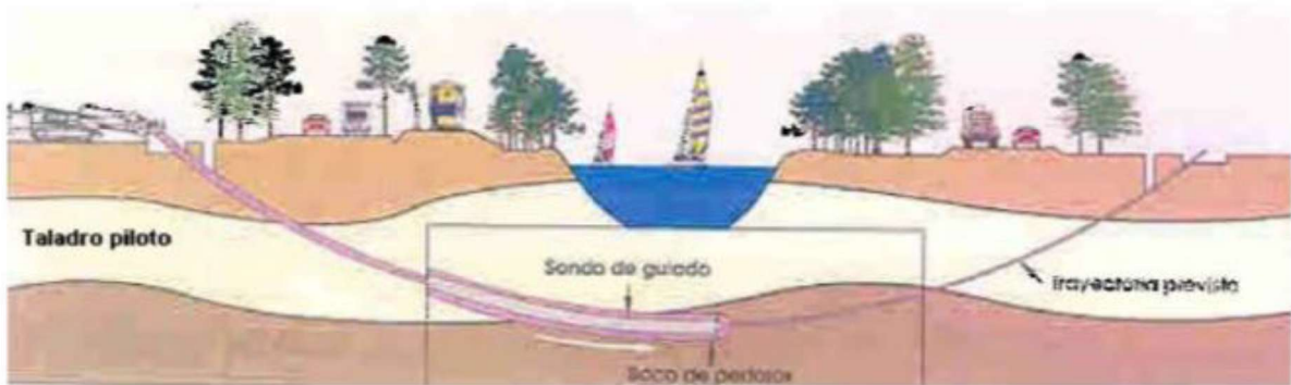
Ilustración 16. Esquema del proceso de perforación piloto
