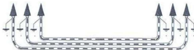
Ilustración 21. Puesta a tierra de cubiertas metálicas
